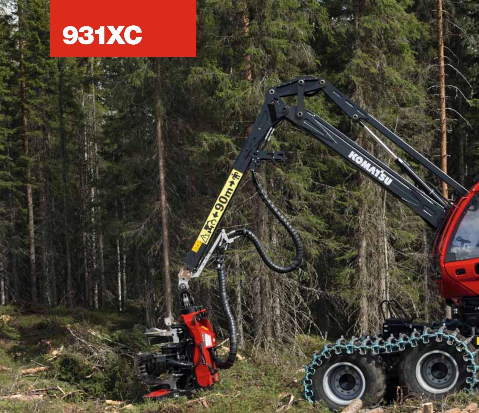
**La procesadora Komatsu 931XC es una máquina potente** que tiene gran estabilidad y baja presión sobre el suelo. Las ocho ruedas se traducen en gran confort de manejo, reduciendo los daños al suelo y excelente movilidad en terrenos muy escarpados:
