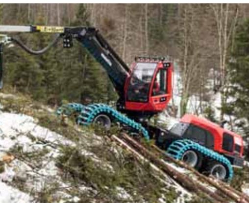
La nivelación de la cabina le permite estar sentado en posición horizontal, por eso no necesita tensar el cuerpo para mantener una buena postura de trabajo.
