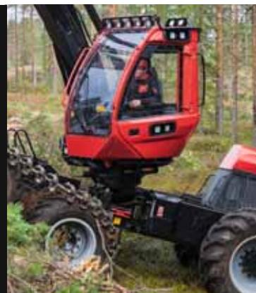
La nueva transmisión hidrostática optimiza la potencia interactuando con el motor y el sistema de control, lo que es particularmente favorable en terrenos escarpados.
