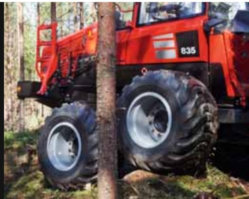
El 835 tiene un nuevo sistema de bastidor con peso optimizado que, combinado con la posibilidad de tener tracks extra anchos, es favorable para el suelo. El bastidor liso en forma de V proporciona una capacidad para salvar obstáculos y una agilidad excepcionales.
