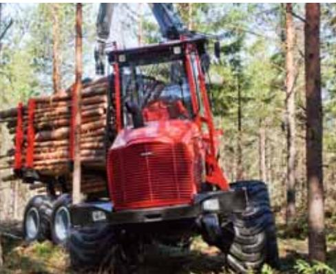
El 835 está construido sobre una plataforma propia en la que se han priorizado los requisitos de flexibilidad y baja presión sobre el suelo.
